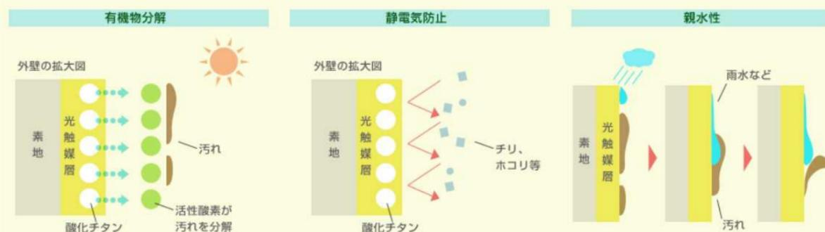
太陽の光を受けると、塗膜中の酸化チタンが活性酸素を生み出します。この活性酸素が汚れを分解し、汚れの付着を弱めます。
